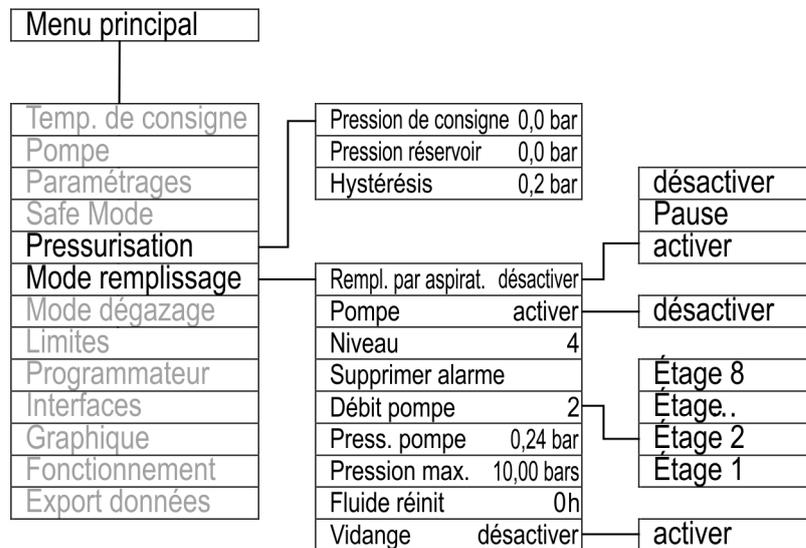
Fig. 88: Structure de menus de la pressurisation
