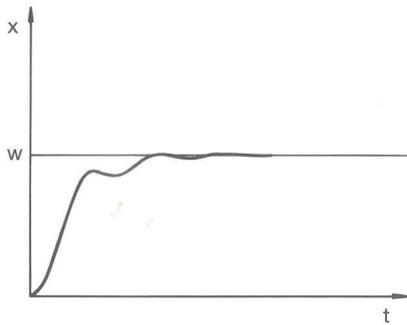
Fig. 75: Paramètre de réglage  $X_p$  trop petit
