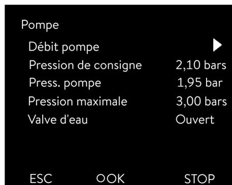
Fig. 37: Menu Pompe sur les appareils Integral XT
