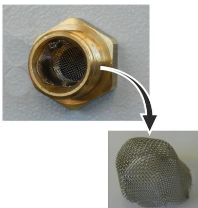
Fig. 96: Retirer le tamis de filtration
