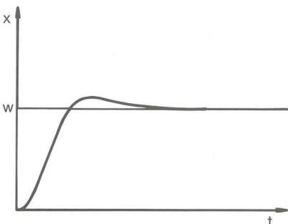
Fig. 74: Paramètre de réglage  $X_p$  trop élevé
