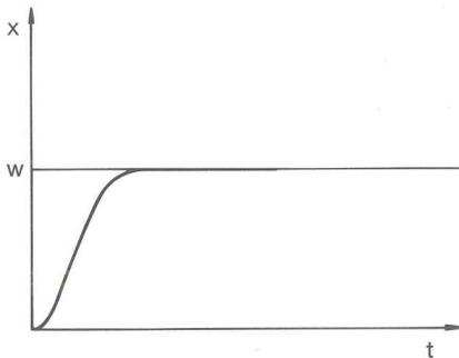
Fig. 73: Réglage optimal
