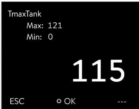
Fig. 43: Saisir la nouvelle  $T_{\max}$ /Réservoir
