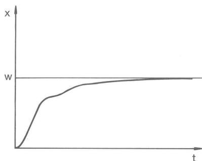
Fig. 77: Paramètres de réglage  $T_n$  et  $T_v$  trop grands
