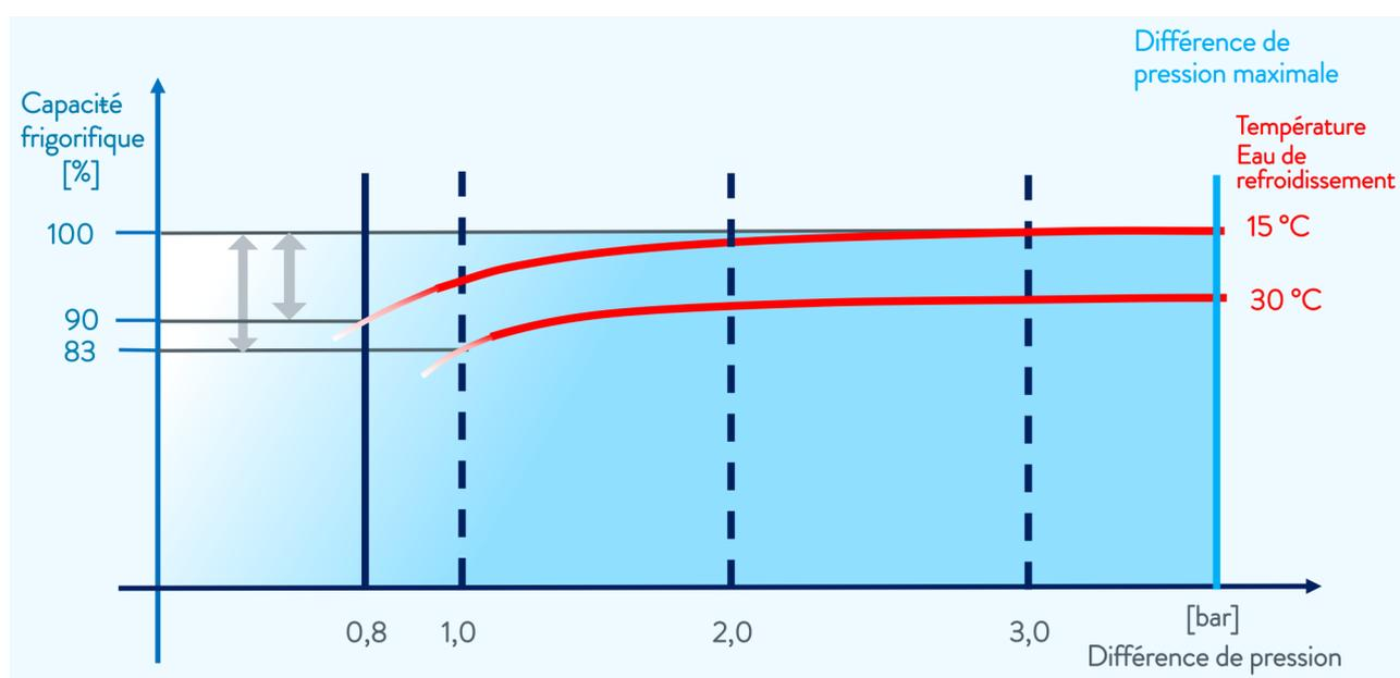
Fig. 102: Différence de pression d'eau de refroidissement
