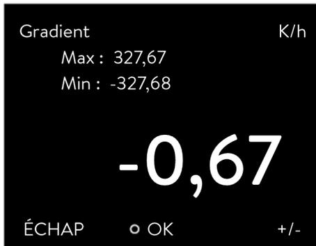
1. Sélectionner les options de menu *Programmeur*  $\rightarrow$  *Rampe*  $\rightarrow$  *Gradient* et saisir le gradient  $-0,67 \text{ (K/h)}$ .
